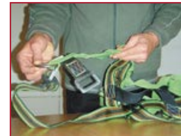
Vérification d'un harnais de sécurité antichute
